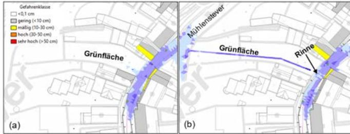
Abb. 2: Beispiel - Überflutung bzw. Gefährdung (a) vor, (b) nach dem Einarbeiten einer Ableitungsrinne im Modell
