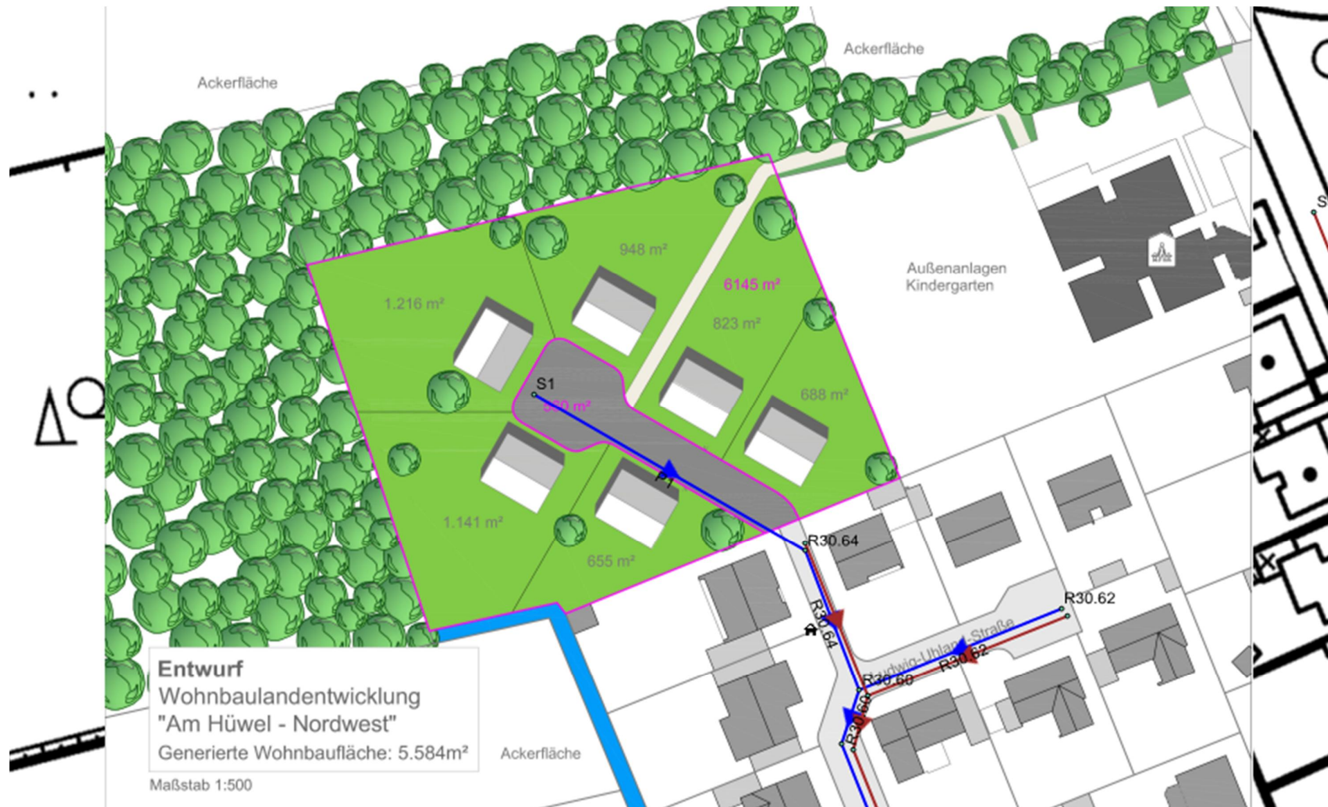
Var 2 – Wohnerweiterung mit Vollanschluss und Sanierung 3 Haltungen
