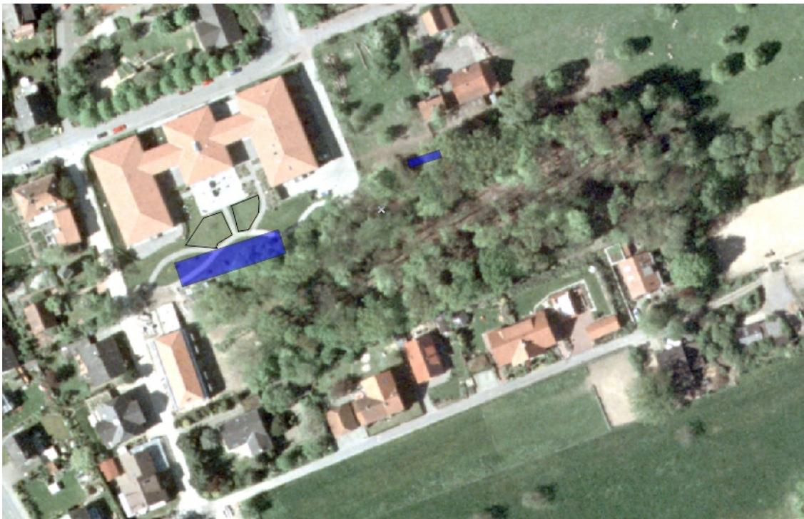
Abb. 8: Rigolenstandorte, links für den Bestand und mit Anschluss an den alten Ablauf als Notüberlauf, rechts dezentral für Flächen, die sich westlich nicht anbinden lassen
