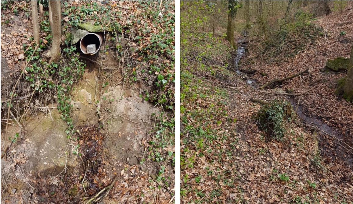
Abbildung 4: Einleitung von Niederschlagswässern des Clara-Stifts (DN 200 PE-Rohr) im westlichen Bereich der Wolfsschlucht (links, Blick N) und Bachlauf entlang der Wolfsschlucht (rechts, Blick E, 17.03.2017)
