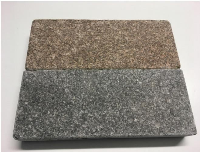
Barrierefreie Übergänge aus Granitsteinpflaster, geflammt
