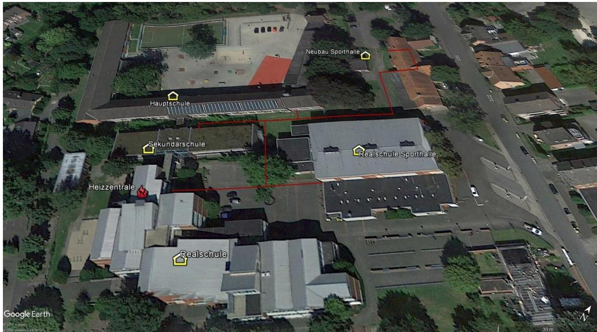
**Abbildung 1: Lage Verbraucher, Heizzentrale und Wärmeleitungen**
