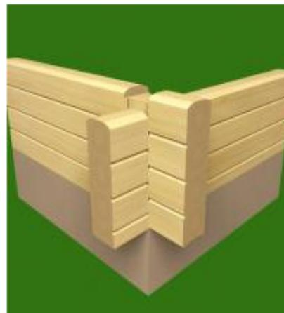
Formstabile Eckverkämmung für ein einschaliges Massivholzhaus
